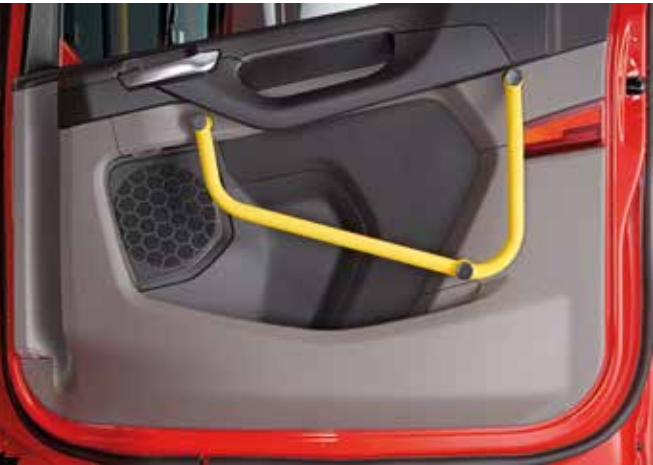
Poręczne, dobrze widoczne uchwyty ułatwiają bezpieczne wchodzenie i wychodzenie z kabiny. Sprawdzają się szczególnie podczas zadań, w których liczy się każda sekunda.
