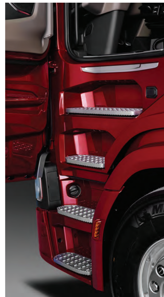
인체공학적 설계의 진입계단 캡 진입계단은 미끄럼을 방지하는 표면으로 되어 있으며, 인체공학적으로 설계되어 캡으로의 안전한 진입을 가능하게 합니다.
