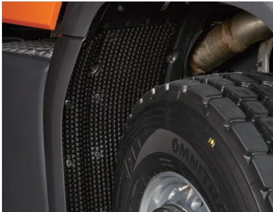
스프레이 서프레이션 젖은 도로 운행 시, 차량으로 이물질이 튀는 것을 줄여줍니다. (S캡)
