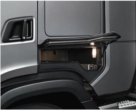
하단 외부 사물함 도어 옆에 추가된 하단 외부 사물함으로 수납공간을 최대한으로 활용할 수 있도록 합니다. (S캡 적용)
