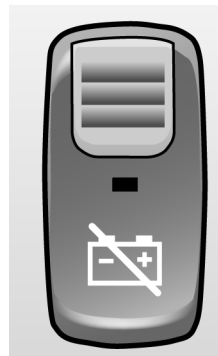
Akkumulátor főkapcsolójának kapcsolója a műszerfalon
