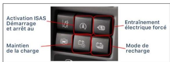
Sur la photo, en haut à gauche : Activation ISAS de la fonction Start & Stop - en bas gauche : charge forcée
