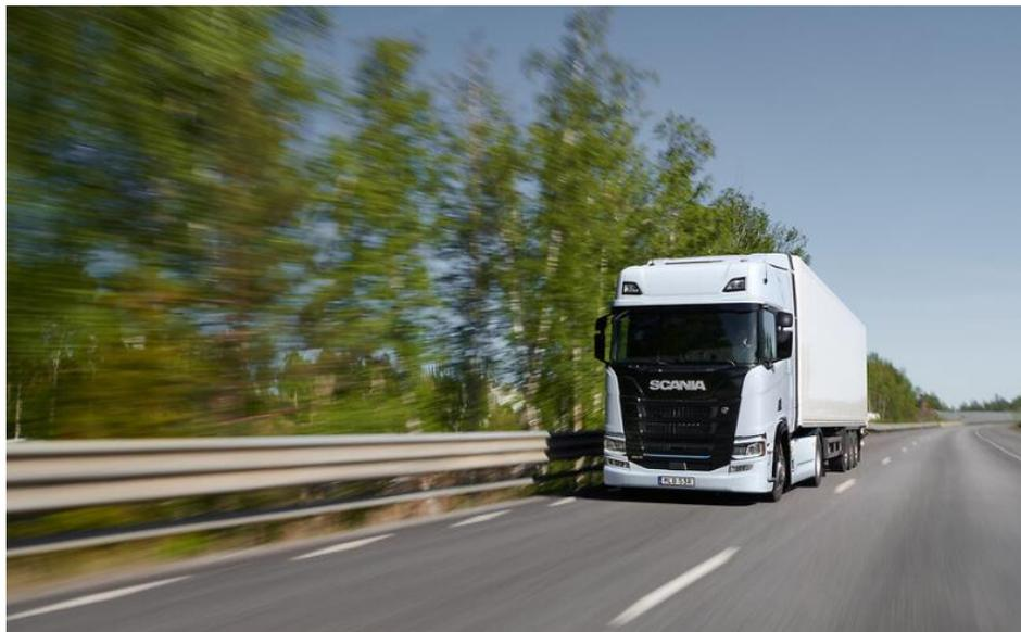
La nouvelle génération de camions électrifiés Scania est disponible aussi bien en versions porteurs que sous forme de combinaisons tracteur/semi-remorque. Les autonomies attendues varient en fonction du poids, de la configuration et de la topographie des parcours, mais on peut attendre d'une combinaison tracteur/semi-remorque 4x2 de 40 tonnes avec six batteries jusqu'à 350 km d'autonomie, sur la base d'une vitesse moyenne de 80 km/h sur autoroute.
