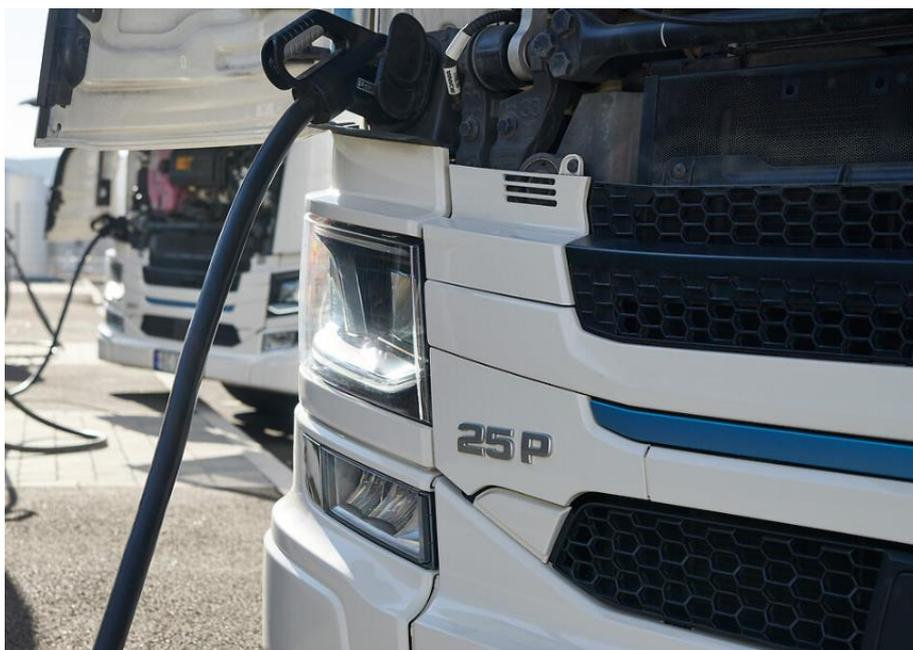
Grâce au circuit de charge CC (courant continu) de 130 kW, les cinq batteries se chargeront en moins d'1 heure et les neuf batteries en moins de d'1,5 heure. Le camion peut également être chargé de manière régénérative lors du freinage .
