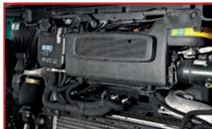
Kabiinitõstepumba kang on kadunud
