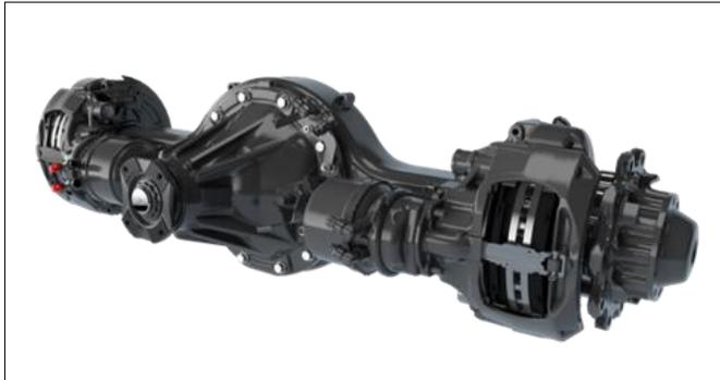
*Die neue Scania Hinterachse des Typs R756 kann mit 8 verschiedenen Achsübersetzungen bestellt werden, von denen die längste bei 1.95:1 liegt. Diese grosse Auswahl an Übersetzungen leistet einen wesentlichen Beitrag zur Herabsetzung der Motordrehzahl während der Fahrt bei Fernverkehr-Lkw, während die grössere Spreizung des Scania Opticruise-Getriebes die notwendige Startfähigkeit gewährleistet.*
