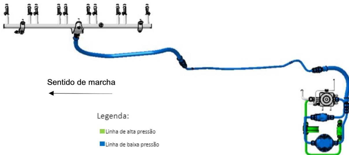
Figura 7: Arquitetura da tubulação de baixa pressão
