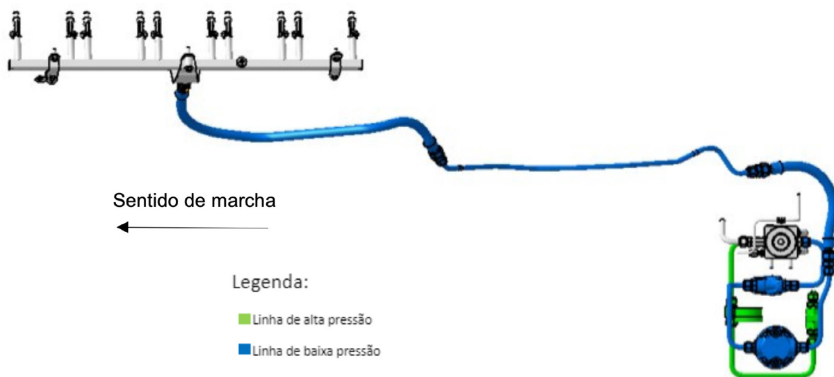
Figura 8: Arquitetura da tubulação de baixa pressão
