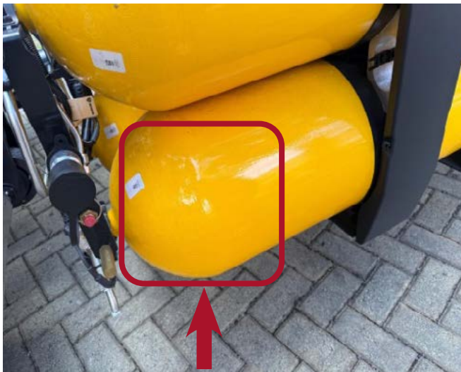
Figura 20: Localização do Serial Number nos cilindros a gás
