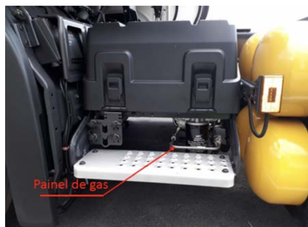
Figura 23: Detalhe da localização do painel de gás sob a caixa de baterias, comum para os veículos
