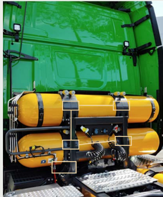
Figura 26: Posição das marcações dos conjunto de suporte dos cilindros atrás da cabine.
