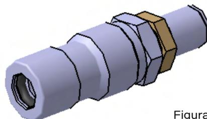
Figura 11: Válvula de abastecimento tipo NGV2
