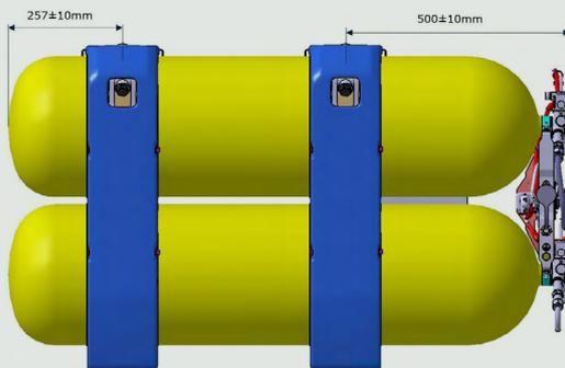
Figura 22: Posicionamento das cintas para cilindros de 80L
