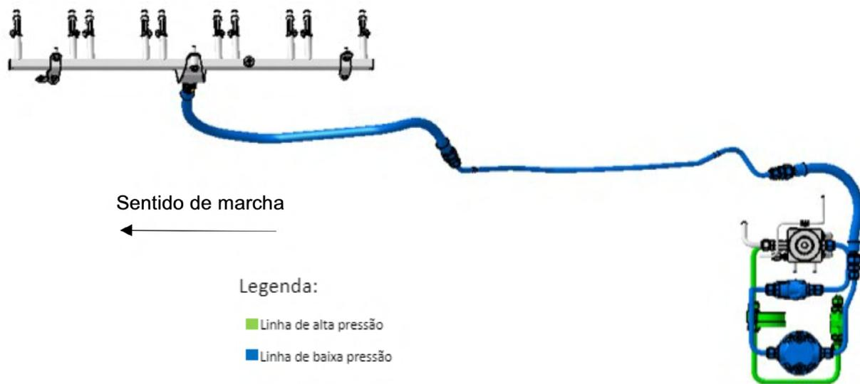
Figura 8: Arquitetura da tubulação de baixa pressão
