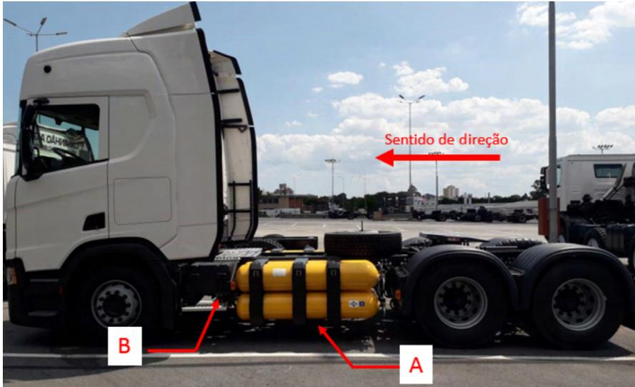
**A** – Exemplo cilindros de 118L posicionados no lado esquerdo do veículo.
