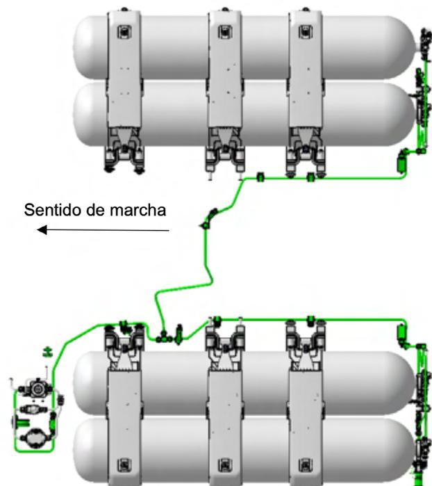
Figura 7: Arquitetura da tubulação de alta pressão na versão somente tubos metálicos
