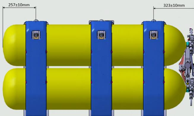
Figura 23: Posicionamento das cintas para cilindros de 95L
