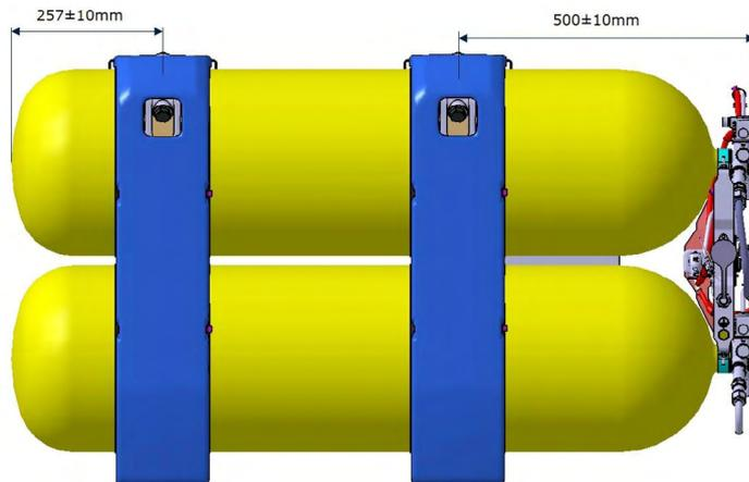
Figura 6: Posicionamento das cintas para cilindros de 80L
