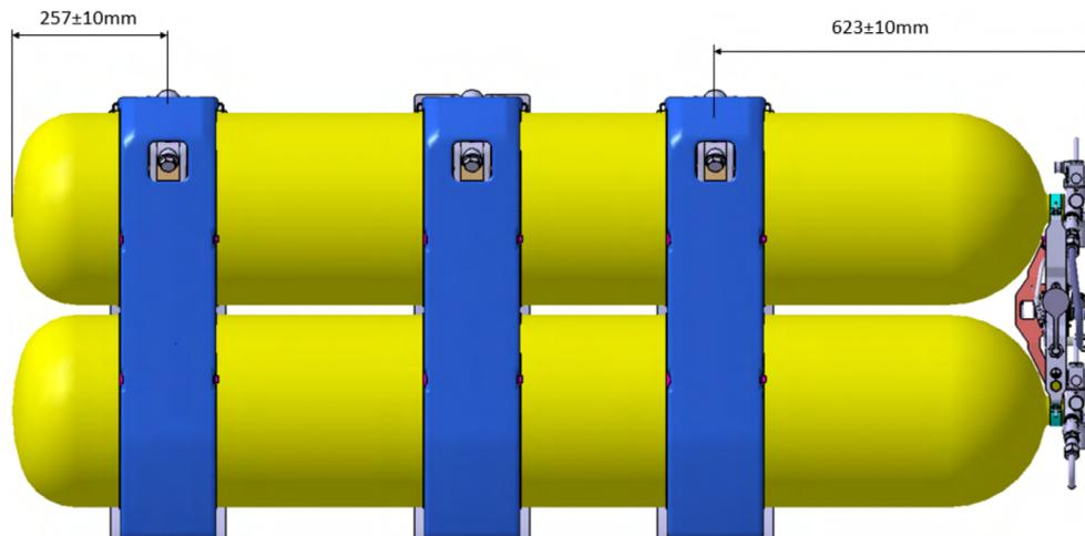
Figura 5: Posicionamento das cintas para cilindros de 118L
