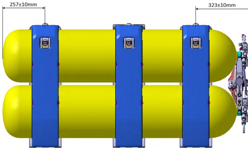
Figura 4: Posicionamento das cintas para cilindros de 95L
