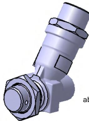
Figura 10: Válvula de abastecimento tipo NBR
