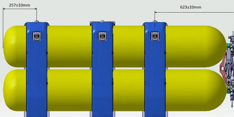
Figura 24: Posicionamento das cintas para cilindros de 118L
