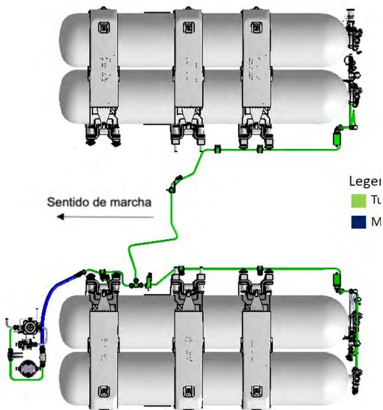
Figura 7.1: Arquitetura da tubulação de alta pressão na versão que contém mangueira flexível.
