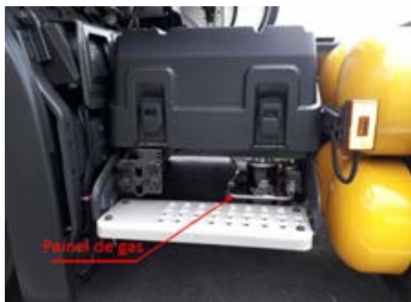
Figura 20: Detalhe da localização do painel de gás sob a caixa de baterias, comum para os veículos
