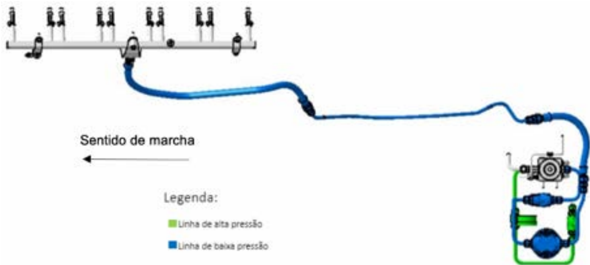
Figura 8: Arquitetura da tubulação de baixa pressão
