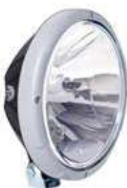
Hella Rallye 3003, 寬型光束, 透明燈殼, Ref. 37.5 Hella鹵素聚光燈, 222 mm。具有銀色飾環的黑色塑膠外殼。透明全玻璃燈殼, 寬型光束。H1燈泡, 未含。建議的 H1 HD 高級更換燈泡: Scania零件編號1905134。 零件編號 1906614
