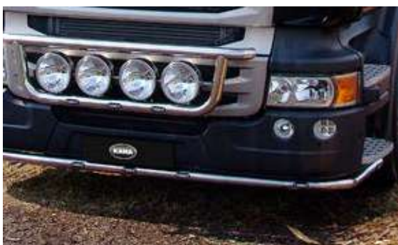
附LED車頭管件，2004車型年份以後G及R系列高保險桿 與具有5個白光前向式LED模組+每邊1個橙色LED模組的零件編號 2203831相同。
