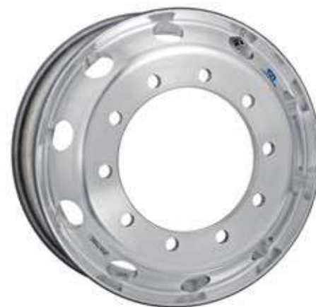
鋁框，Dura Flange Dura Flange是獲得專利的處理技術，能提供凸緣額外保護並延長使用壽命。 22.5 x 8.25。零件編號 2300494 22.5 x 9.00。零件編號 1911071 22.5 x 11.75。零件編號 2156540
