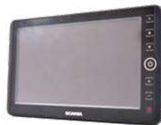
監視器，8吋 連接三部以內的攝影機。 零件編號 2660322
