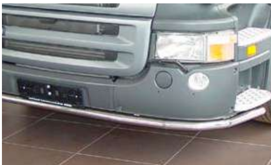
車頭管件，2004車型年份以後G及R系列高保險桿 拋光不鏽鋼風格管件，不含LED。
