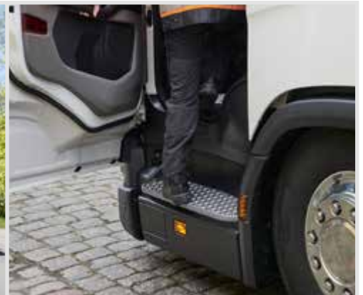
Rad Scania L môže byť vybavený automatickým kneelingom, s ktorým má vozidlo nástupný schodík len 44 centimetrov nad zemou. Okrem toho, že je nízko, je nástupný schodík tiež široký, čo oceňujú všetci tí, ktorí počas dňa často nastupujú a vystupujú z kabíny.
