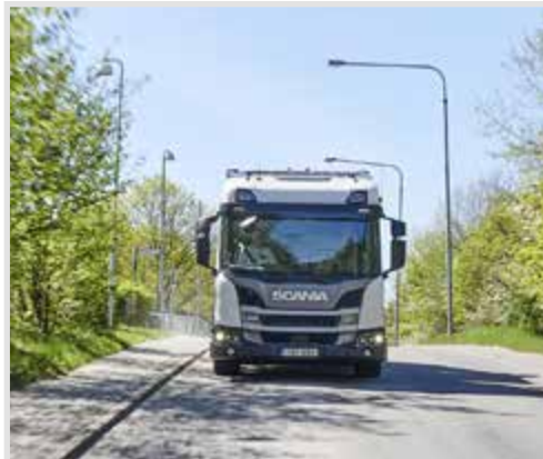
Rad Scania L môže byť vybavený automatickým kneelingom, s ktorým má vozidlo nástupný schodík len 44 centimetrov nad zemou. Okrem toho, že je nízko, je nástupný schodík tiež široký, čo oceňujú všetci tí, ktorí počas dňa často nastupujú a vystupujú z kabíny.
