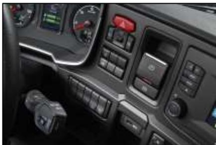
*A Scania está a introduzir um travão de estacionamento elétrico, o equipado com funções de segurança. É aplicado automaticamente (a baixa velocidade) quando a porta do condutor é aberta ou o cinto de segurança é desapertado.*
