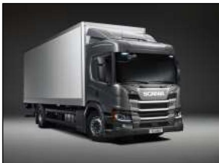
*As cabinas P da Scania são clássicas e modernas, para aplicações tanto no sector da construção como da distribuição, onde muitas vezes é necessário conduzir no meio do tráfego urbano e com um melhor contacto com o seu ambiente envolvente numa cabina que fica instalada a uma altura ligeiramente inferior. A ilustração mostra uma cabina CP17 com um tejadilho normal.*
