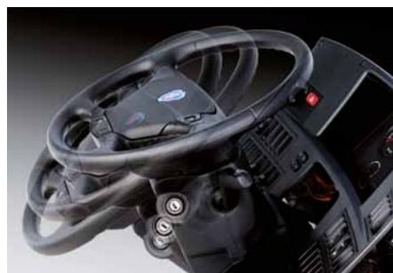
**Volante multi-funcional** Totalmente ajustável e equipado com comandos integrados, o volante permite o controlo total do computador de bordo, bem como os controlos de velocidade de cruzeiro e velocidade nas descidas através da alavanca combinada Scania Opticruise e Scania Retarder.
