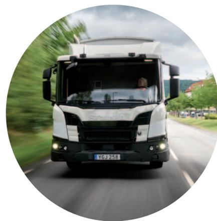
A suspensão pneumática dianteira baixa 100 milímetros, quando o condutor coloca o travão de mão.
