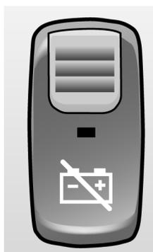
*Переключатель для выключателя массы аккумулятора на панели приборов*
