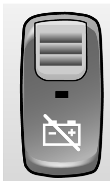
Przełącznik głównego wyłącznika zasilania na tablicy rozdzielczej
