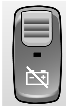
인스트루먼트 패널의 배터리 마스터 스위치용 스위치
