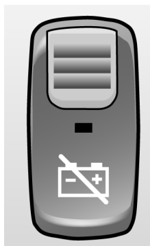
Spínač odpojovače akumulátorů v přístrojové desce
