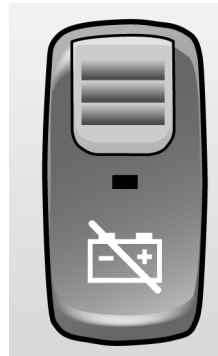
Gösterge panelindeki akü ana anahtarı düğmesi
