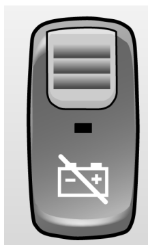
Przełącznik głównego wyłącznika zasilania na tablicy rozdzielczej
