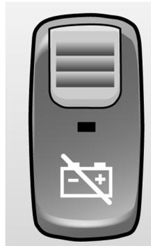
*Commutateur de coupe-batterie au tableau de bord*
