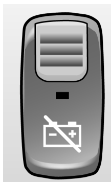
Akkupääkatkaisimen kytkin kojetaulussa
