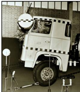
*Ces essais rigoureux au cours desquels une cabine subit toute une série de tests aux procédures distinctes sont toujours un maillon important du protocole Scania au moment du développement de nouvelles cabines. La photo ci-dessus montre un banc d'essai en 1968.*
