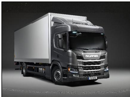
*Las cabinas P de Scania son elementos clásicos modernizados para su aplicación en los sectores de la construcción y la distribución, en los que el conductor suele desenvolverse en tráfico urbano y goza de un contacto más directo con el entorno desde una cabina montada en una posición ligeramente inferior. En la ilustración se muestra una cabina CP17 con techo estándar.*
