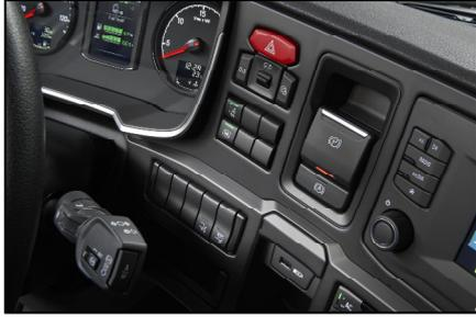
*Scania va a presentar un freno de estacionamiento eléctrico equipado con funciones de mejora de seguridad. Se aplica de forma automática (a bajas velocidades) cuando la puerta del conductor se abre o se desabrocha el cinturón de seguridad.*
