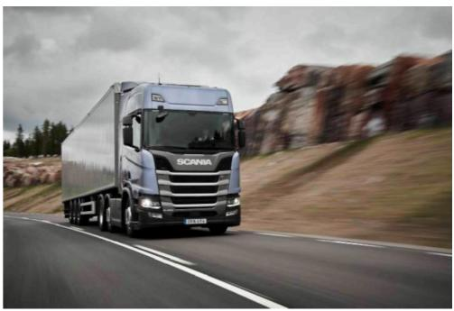
Благодаря улучшенной системе торможения, сдвинутой вперед передней оси и пониженному центру тяжести, тормозной путь типового тягача Scania в 40 тонн полной массы на крейсерской скорости (80 км/ч) на пять процентов короче, чем раньше
