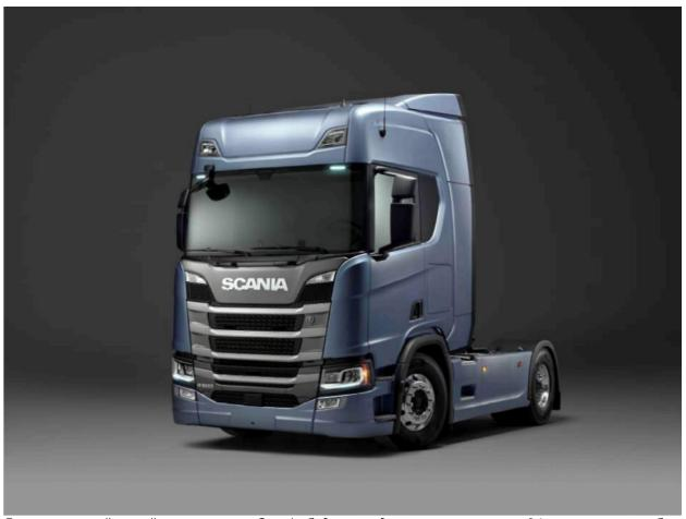
В рамках новой линейки грузовиков Scania будет представлено не менее 24-х вариантов кабин. На фотографии изображен тягач с кабиной серии R обычной конфигурации.
