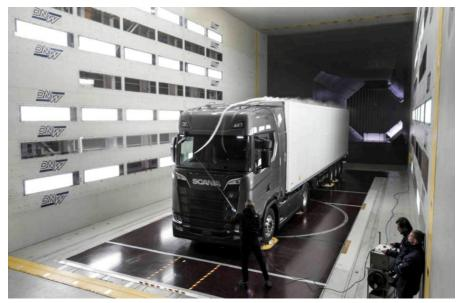
В процессе разработки Scania стремилась создать максимально аэродинамическую конструкцию в индустрии. Scania основывалась на успешном опыте Scania Streamline, и результатом стал настолько обтекаемый грузовик для дальних перевозок, что его расход топлива уменьшен на два процента за счет низкого сопротивления воздуха.
