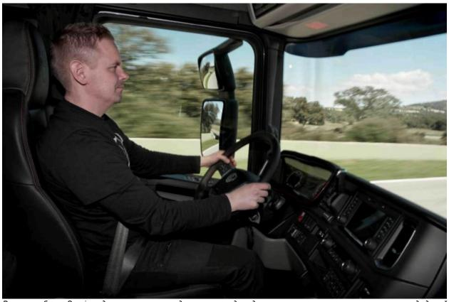
В новых кабинах Scania водительское место сдвинуто вперед и одновременно в сторону по сравнению с предыдущей линейкой. В дополнение к большим возможностям регулировки сиденья водители получают более широкий обзор пространства вокруг кабины.
