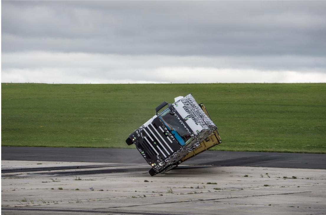
*Durante il processo di sviluppo, sia i telai sia le cabine della nuova generazione di veicoli Scania vengono sottoposti a numerosi e severi test. Le cabine Scania devono superare alcune prove durante le quali subiscono impatti da diverse direzioni, analogamente a ciò che accade in un incidente reale, ad esempio in caso di ribaltamento.*
