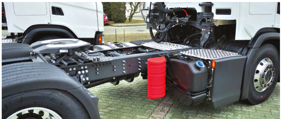
▲ A tömegcsökkentés érdekében a járműveket könnyűfém keréktárcsákkal, százötven milliméterrel, rövidebb tengelytávolsággal és háromszáz literes gázolajtartállyal specifikálták.
