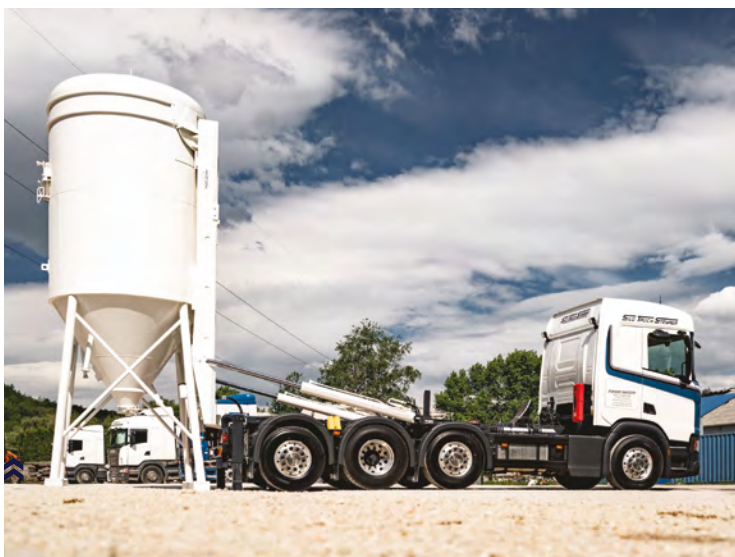
Az m-tec zsebes silóállító felépítményével gyorsan és könnyen telepíthetők a mobilsilók az építési területeken.
