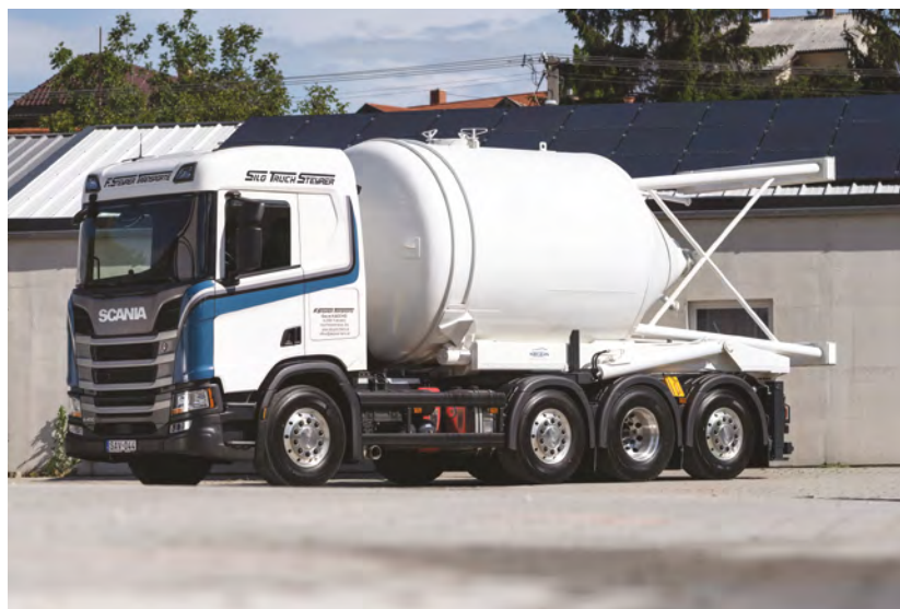
➤ Azért szükséges a hátsó hármastengelycsoport, mert visszashállításakor a mobilsiló aljában összegyűlt maradék anyag a jármű hátulját terheli leginkább.
