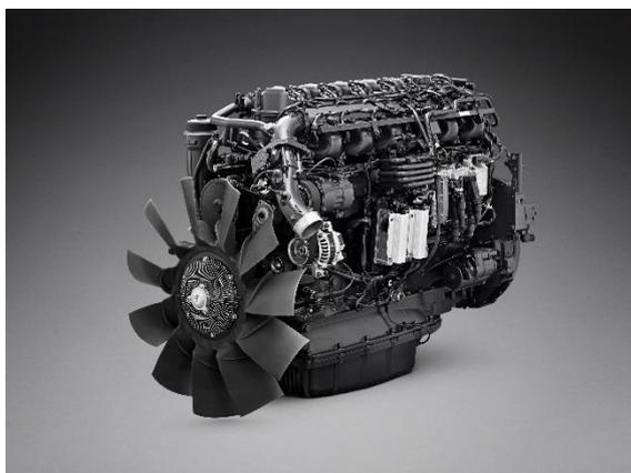
*Le nouveau moteur gaz 13 litres de Scania délivre une puissance de 410 chevaux. Avec 2 000 Nm de couple atteints dès 1 100 tr/min, il dispose de toute la puissance et de l'autonomie (même avec des réservoirs de GNC) nécessaires pour les véhicules de chantier classiques sur un marché comme la France, où l'infrastructure GNC est en constante évolution.*
