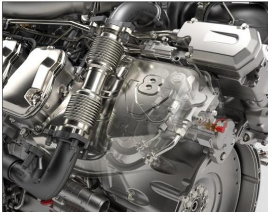
*La nouvelle génération de moteurs V8 Scania est équipée d'une pompe à carburant avec dosage d'admission actif pour des performances optimales sur le plan de la consommation de carburant.*
