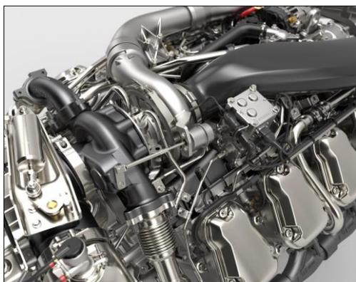
*Le puissant DC16 123 produit ses 770 ch grâce à de plus gros injecteurs et à un turbocompresseur FGT à roulements à billes, ce qui se traduit par une réponse plus rapide et une combustion améliorée.*
