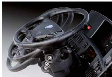
**Volante multifuncional** Completamente ajustable y equipado con mandos integrados, el volante permite un control absoluto del ordenador de a bordo, además de los controles de velocidad y descenso de pendientes mediante la palanca combinada de Scania Opticruise y Scania Retarder.
