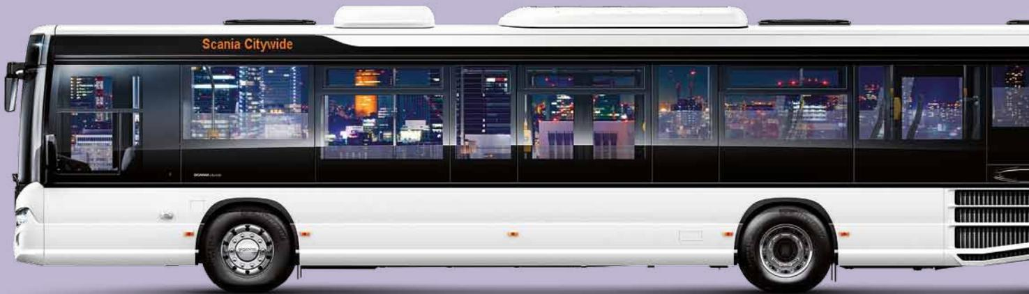
• **Scania Citywide LF (piso bajo)** está diseñado para rutas urbanas donde son esenciales un flujo rápido de pasajeros y la máxima capacidad. El piso bajo en toda la longitud ofrece un interior luminoso y espacioso así como una configuración flexible.
