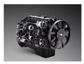
La opción de combinar el nuevo motor Scania de 7 litros con una cabina P también permite elegir un túnel de motor bajo de 95 milímetros. Esto supone un mayor espacio y mayor facilidad de movimiento dentro de la cabina.
