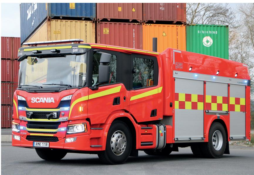
Nicht alles, was in anderen europäischen Staaten erlaubt ist, darf auch in Deutschland verbaut werden: Die Sondersignalanlage des schwedischen HTLF mit drei Paar Frontblitzern und seitlich in den Aufbau eingelassenen blauen LED-Blinkleuchten ist in Deutschland in der Regel nicht zulassungsfähig.
