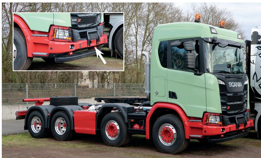
Vor allem in der Baubranche finden die XT-Fahrgestelle, wie hier ein Scania R650 V8 XT, mit der auch für die CrewCab lieferbaren XT-Stahlstoßstange (kleines Bild) inklusive 400-kN-Zugmaul Verwendung.
