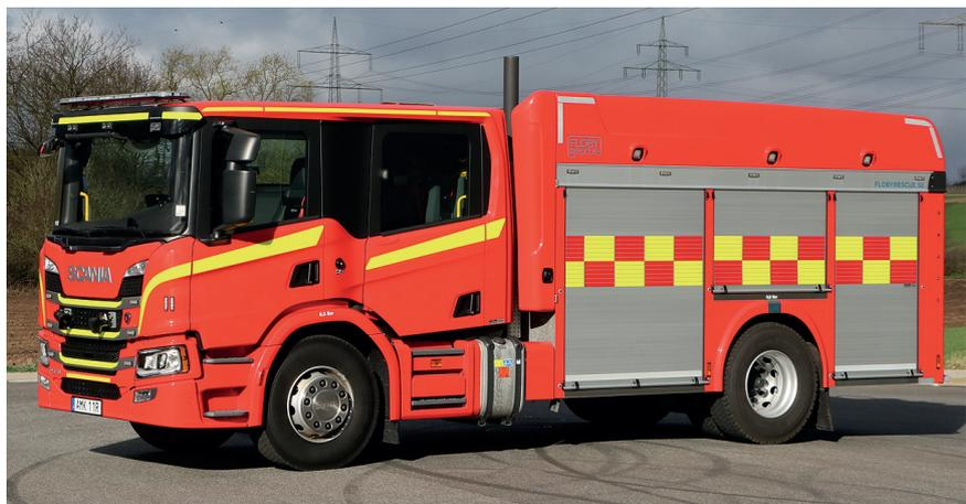
Ein schwedisches HTLF mit der Scania CrewCab CP 31. Das Vorführfahrzeug mit 3 000 Litern Wasser und 300 Litern Schaummittel wurde von Floby auf einem Scania P 370 B 4 × 2 NB aufgebaut.
