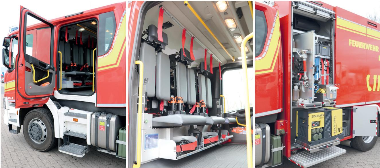
**links:** Der untere Tritt beim Einstieg in den Mannschaftsraum klappt automatisch aus. **mitte:** Entgegen der Fahrtrichtung sind drei Plätze mit Halterungen für Pressluftatmer ausgestattet; in Fahrtrichtung zwei Plätze. **rechts:** Im Geräteraum G1 wird ein 14-kVA-Stromerzeuger mitgeführt.
