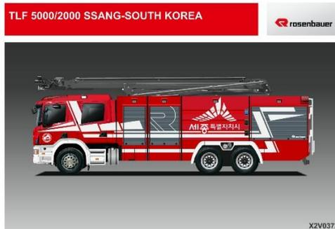
Ein Einsatzfahrzeug von Rosenbauer mit Allradantrieb auf Basis eines Scania P 460 mit Mannschaftsfahrerhaus. Der kraftvolle 13-Liter-Motor gewährleistet ein schnelles Ausrücken.
