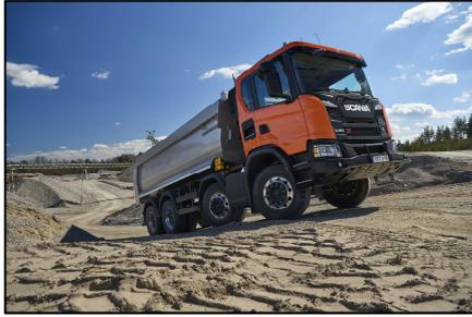
*Mit dem XT stellt Scania ein Modell für härteste Aufgaben vor, für die Robustheit, Produktivität und Verfügbarkeit unerlässlich sind. Der wuchtige Stoßfänger weist einen Überstand von 150 Millimetern auf. In Kombination mit der Unterboden-Schutzplatte und dem Scheinwerferschutz ist die Fahrzeugfront bestens geschützt.*
