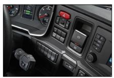
Scania führt eine elektrische Feststellbremse mit Sicherheitsfunktionen ein. Sie wird bei niedriger Geschwindigkeit automatisch betätigt, wenn der Fahrer die Tür öffnet oder den Sicherheitsgurt löst.
