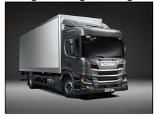
Die P-Fahrerhäuser von Scania sind moderne Klassiker für Anwendungen im Bau- und Verteilerverkehr mit häufigem Fahren im Stadtverkehr, wo man mit einem niedrigeren Fahrerhaus eine bessere Übersicht über seine Umgebung hat. Die Abbildung zeigt ein CP17 Fahrerhaus mit normalem Dach.
