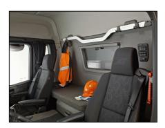
Scania baut nun das für die neue Generation verfügbare Fahrerhausangebot in großen Schritten aus. Die Abbildung zeigt das Innere der neuen mittellangen Variante des G-Fahrerhauses mit normaler Dachhöhe (CG17N).
