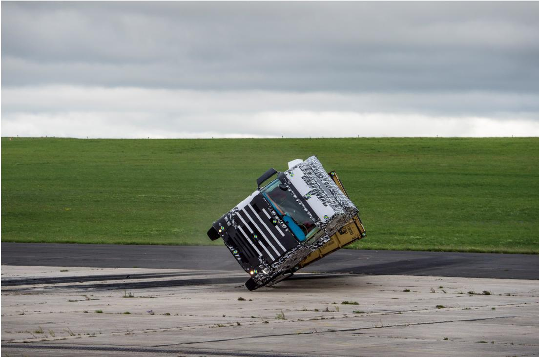
*Sowohl die Rahmen als auch die kompletten Fahrerhäuser der neuen Scania Lkw-Baureihe werden während des Entwicklungsprozesses härtesten Tests unterzogen. Die Fahrerhäuser von Scania halten Versuchen stand, bei denen ein Fahrerhaus einem Aufprall aus mehreren Richtungen ausgesetzt wird, um ein reales Unfallgeschehen, beispielsweise mit Überschlag, zu simulieren.*
