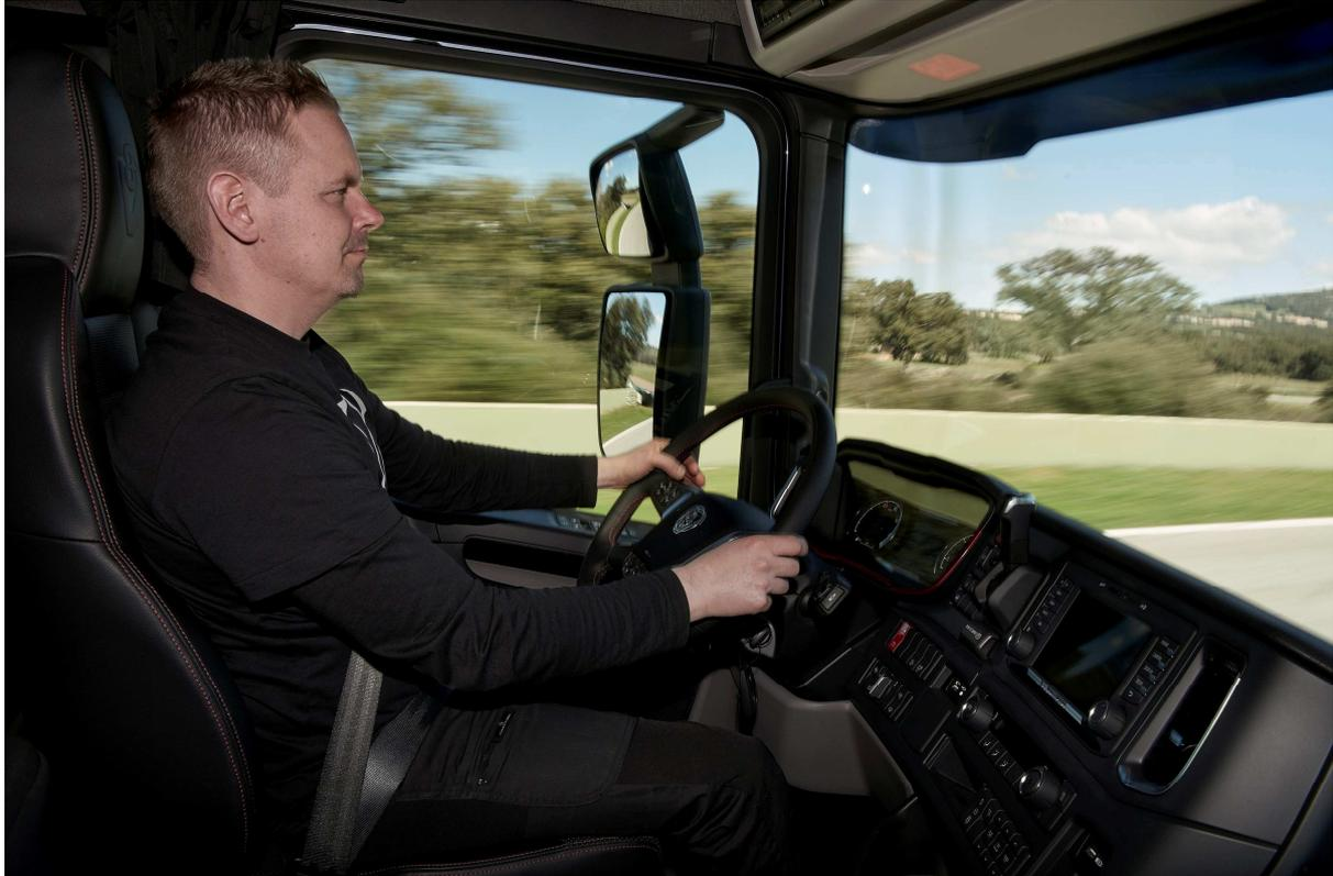
*Bei den neuen Fahrerhäusern von Scania wurde die Sitzposition des Fahrers nach vorne und zur Seite versetzt. Neben noch mehr Einstellungsmöglichkeiten für den Sitz profitiert der Fahrer auch von einem verbesserten Überblick über die direkte Umgebung des Lkw.*
