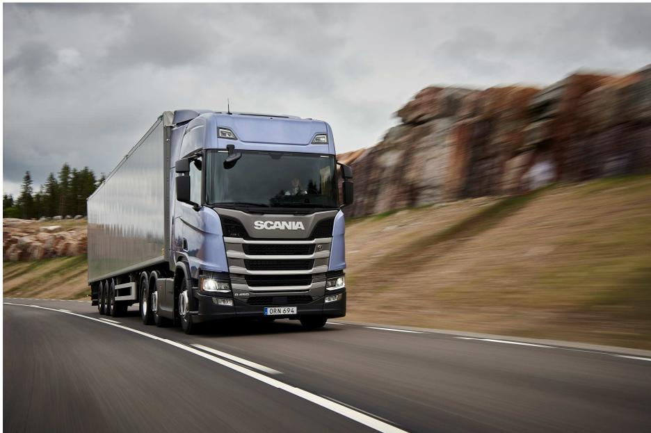
*Dank eines weiterentwickelten Bremssystems, einer noch weiter nach vorne versetzten Vorderachse und einem tieferen Schwerpunkt erzielt eine typische Scania Sattelzugmaschine mit einem Gesamtzuggewicht von ca. 40 Tonnen beim Bremsen aus einer Geschwindigkeit von 80 km/h unter normalen Bedingungen einen um 5 Prozent verkürzten Bremsweg.*
