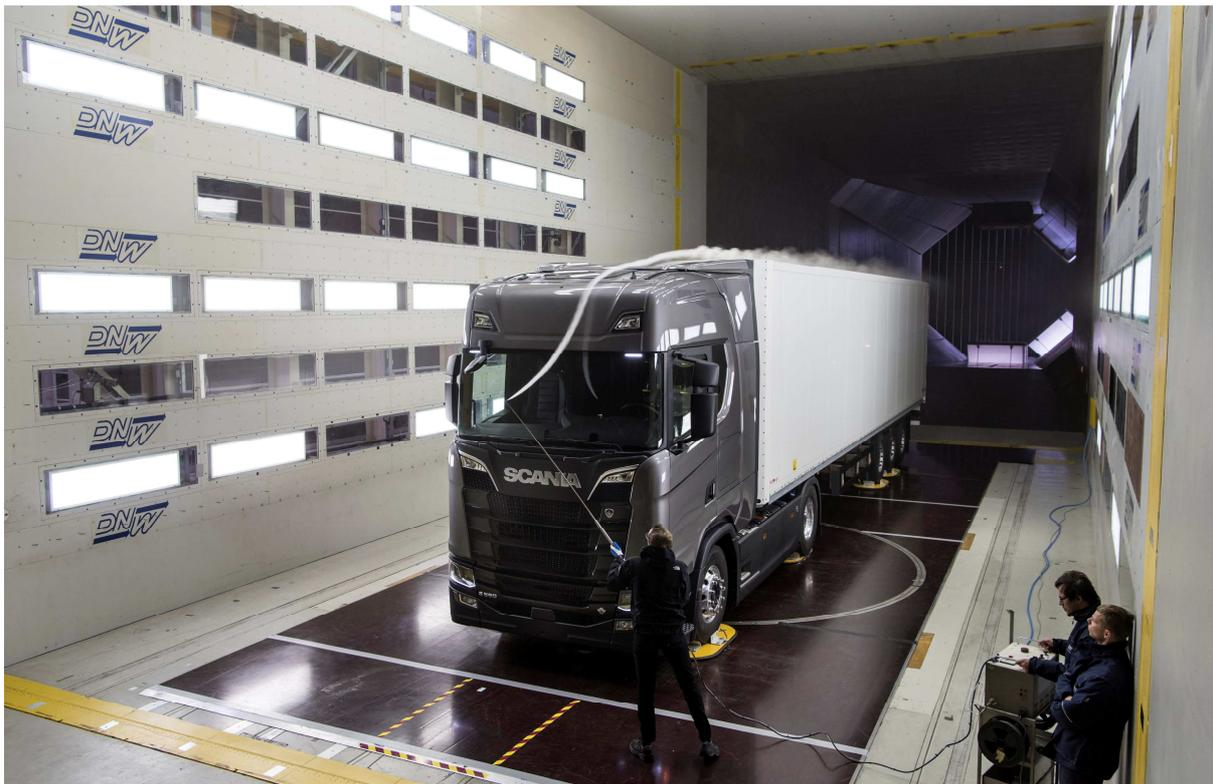
*Eine Aerodynamik, die innerhalb der Branche wegweisend ist, war eines der Ziele von Scania während des Entwicklungsprozesses. Scania hat an die hervorragenden Erfahrungen mit dem Scania Streamline angeknüpft. Ergebnis ist ein so windschnittiger Lkw, dass die Fernverkehrs-Version dank des niedrigeren Luftwiderstands den Kraftstoffverbrauch um 2 Prozent senken kann.*
