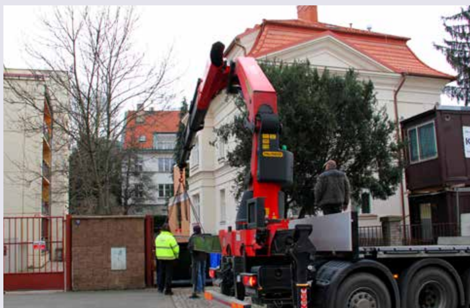
Maximální vyložení ramene Palfinger je 14 m, se šesti tunami je to ale méně
