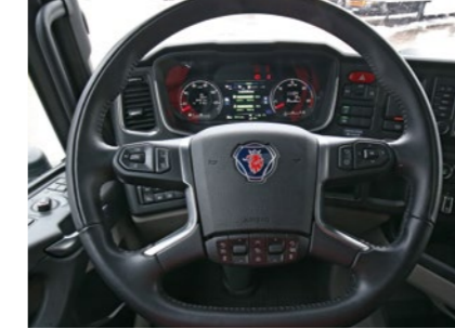
Der informative Bordcomputer wird über die Lenkradtasten bedient
