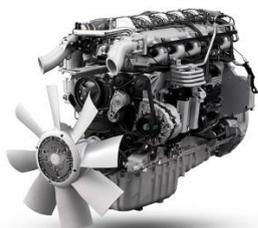
*Le moteur gaz de 9 litres Scania est disponible en deux niveaux de puissance pour l'Euro 6 : 280 et 340 ch. Il peut désormais équiper la nouvelle génération de camions où, à l'instar de ses cousins diesels, il permettra de réduire la consommation de gaz grâce aux améliorations apportées à l'aérodynamique.*
