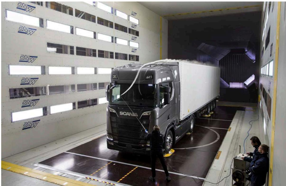
*Offrir la meilleure aérodynamique du secteur a été l'un des objectifs de Scania pendant le processus de développement. Scania s'est inspiré des excellentes expériences acquises avec Scania Streamline et le résultat est un véhicule si profilé qu'un camion long courrier peut désormais réduire sa consommation de carburant de deux pour cent grâce à sa moindre résistance à l'air.*
