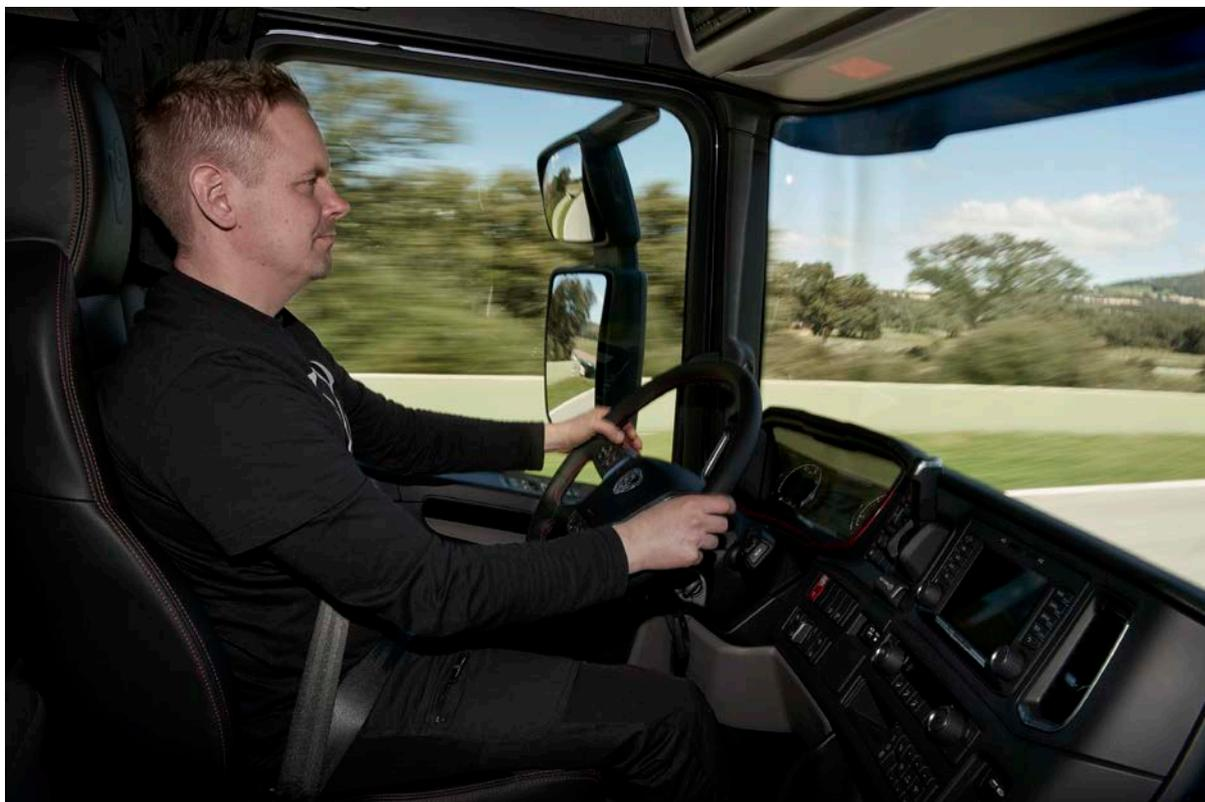
*Dans les nouvelles cabines Scania, la position d'assise du conducteur a été avancée et rapprochée de la paroi par rapport à la gamme actuelle. Outre la marge de réglage supérieure du siège, le conducteur bénéficie, par exemple, d'une vue d'ensemble encore plus dégagée des alentours immédiats du camion.*
