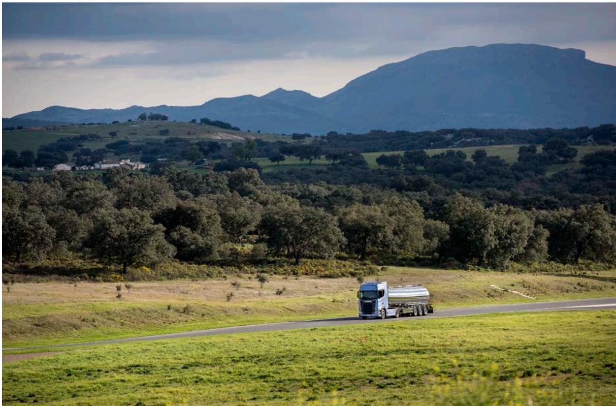
*Die neue Lkw-Generation von Scania kann problemlos mit hydriertem Pflanzenöl (HVO) betrieben werden, ohne dass Wartungsbedarf oder Fahrzeugleistung beeinflusst werden. HVO kann auch mit herkömmlichem Dieseldieselkraftstoff gemischt werden. Wird nur HVO getankt, können die CO<sub>2</sub>-Emissionen sogar um bis zu 90 Prozent gesenkt werden.*
