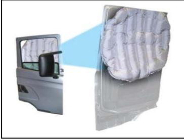
*Die Fahrerhäuser der neuen Scania Lkw-Baureihe können mit Seitenairbags ausgestattet werden – ein Novum in der Lkw-Branche. Verletzungen der Fahrer, die beispielsweise entstehen, wenn der Lkw durch ein Ausweichmanöver von der Fahrbahn abkommt und kippt oder sich überschlägt, stellen im Transportgewerbe eine erhebliche Gefährdung dar.*
