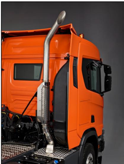
*Scania propose une prise d'air surélevée en deux versions, quadruplant le temps de fonctionnement dans la version HD.*
