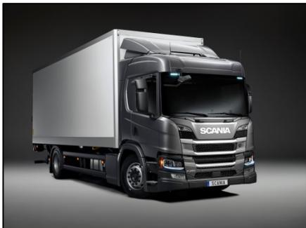
*Les cabines P Scania sont des classiques modernes pour les métiers de la construction et de la distribution où les déplacements s'effectuent souvent en milieu urbain. Le léger abaissement de la cabine permet au conducteur de mieux voir ce qui l'entoure. La photo montre une cabine CP17 avec pavillon normal.*
