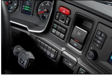
*Scania propose un frein de stationnement électrique avec plusieurs fonctions de sécurité. Il se serre automatiquement (à vitesse réduite) quand la portière du conducteur est ouverte ou quand la ceinture de sécurité est détachée.*
